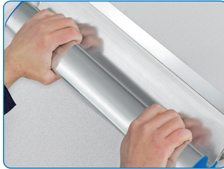
Bei großen Breiten beidhändige und damit kräftesparende Führung
